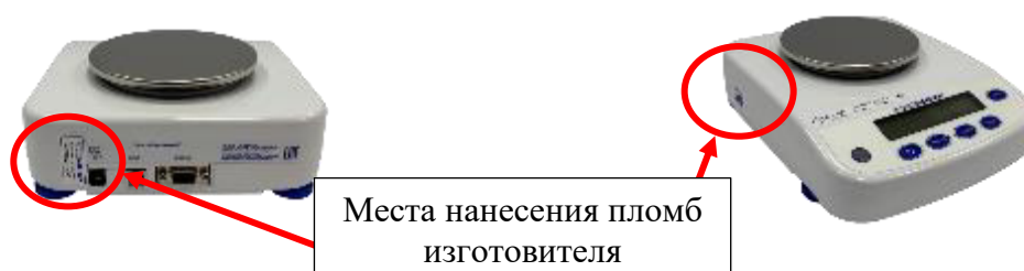
Рисунок 5 – Схема пломбировки для весов ВТ
