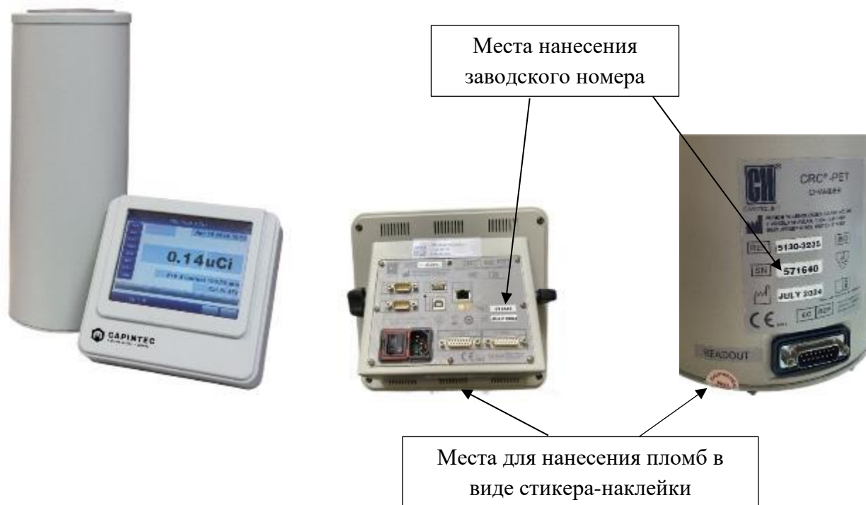
Рисунок 1 – Общий вид CRC-55tPET с указанием мест пломбирования и нанесения заводского номера
