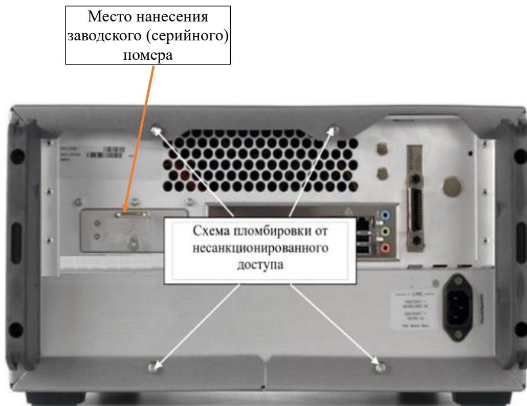
Рисунок 5 – Внешний вид базового блока N1000A, вид сзади
