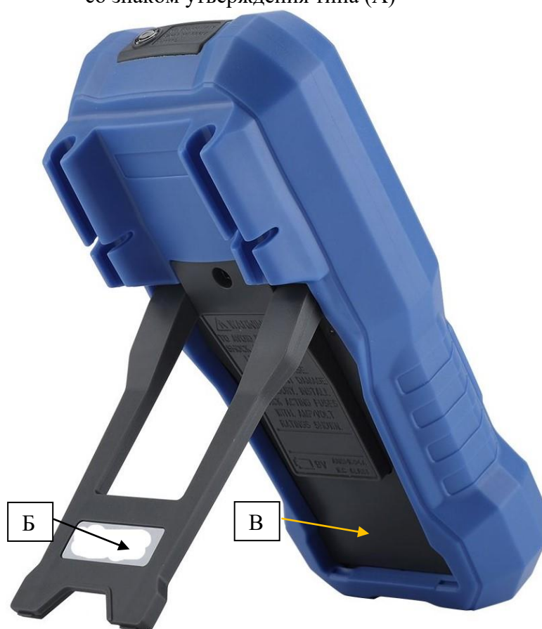
Рисунок 2 – Задний вид мультиметров и места нанесения серийного номера (Б) и наклейки со знаком поверки (В)
