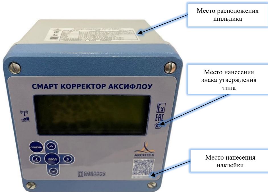
Рисунок 2 – Общий вид смарт корректора АКСИФЛОУ, указание места расположения знака утверждения типа, наклейки и шильдика
