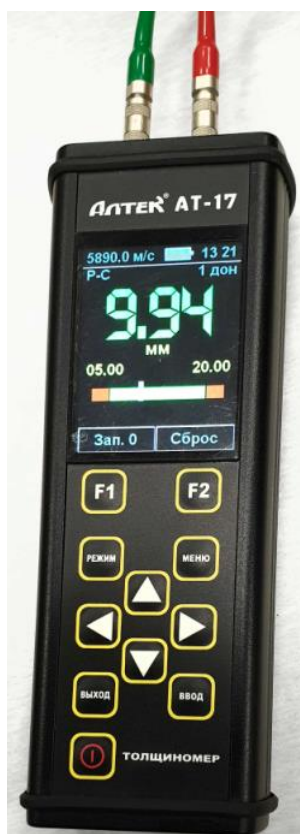
Рисунок 1 – Общий вид электронного блока толщиномеров
