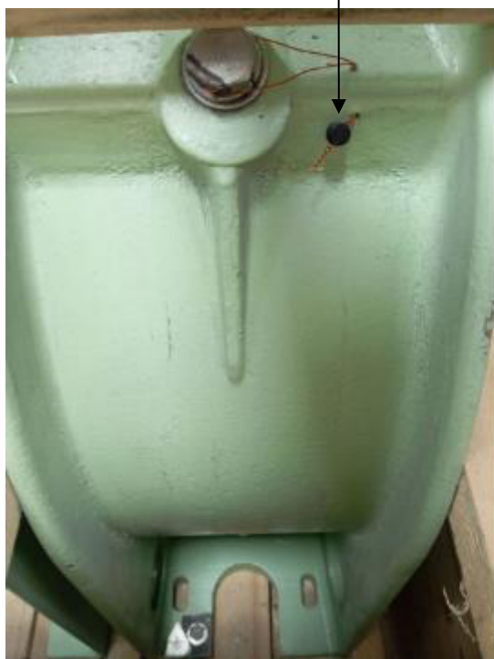
Рисунок 1 – Общий вид трансформаторов (исполнение ТШВ 15) с указанием места ограничения доступа к местам настройки (регулировки)
