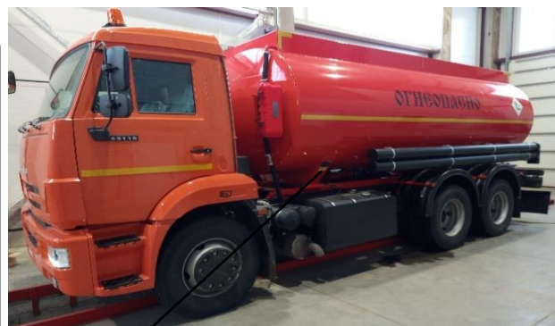
1 – место расположения информационной таблички с указанием вместимости АЦ и АТЗ 2 – общий вид информационной таблички с указанием вместимости АЦ и АТЗ
