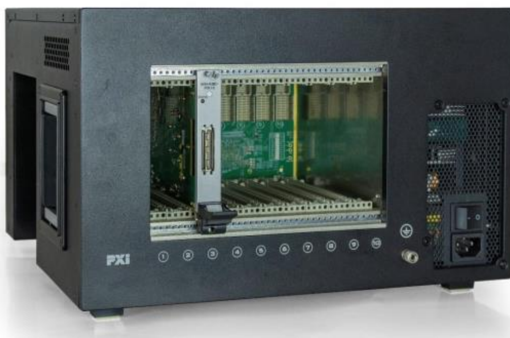
Рисунок 2 – Измеритель мгновенных значений напряжения МН32-4И8С-РХІе, установленный в моноблок
