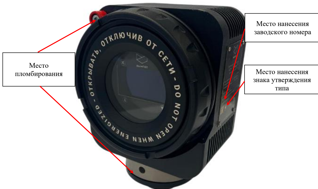
Рисунок 1. Общий вид преобразователей точки росы КОНГ-Прима-2М исполнений КРАУ2.848.015-03, КРАУ2.848.015-04, с указанием мест нанесения знака утверждения типа, заводского номера и пломбировки от несанкционированного доступа
