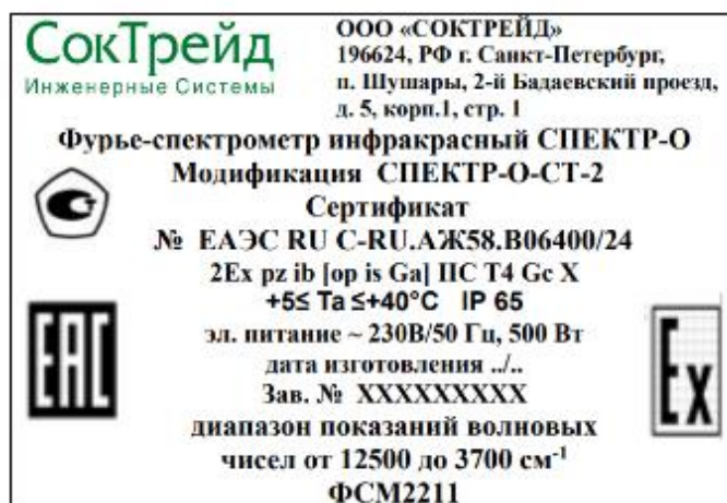
Рисунок 4 – Шильдик спектрометра СПЕКТР-О-СТ-2 с блоком интерферометра ФСМ 2211
