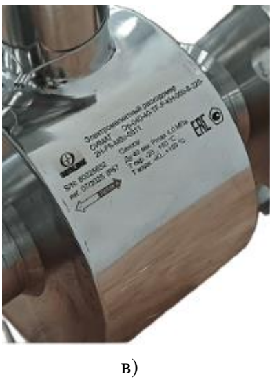
Рисунок 6 – Вид маркировочной этикетки сенсора и места ее нанесения на сенсоры различного исполнения:
