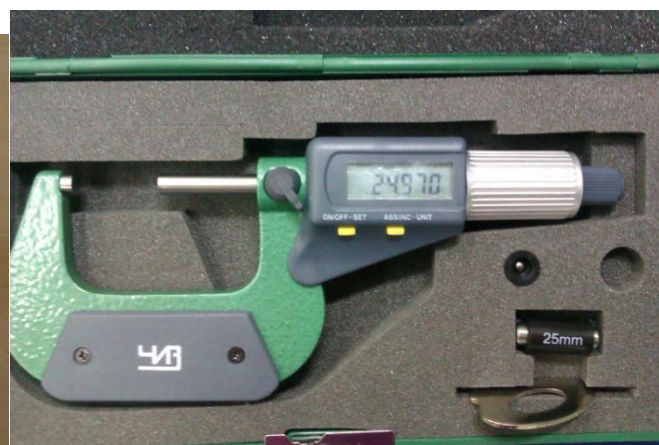
Рисунок 2 – Внешний вид микрометров типа МК
