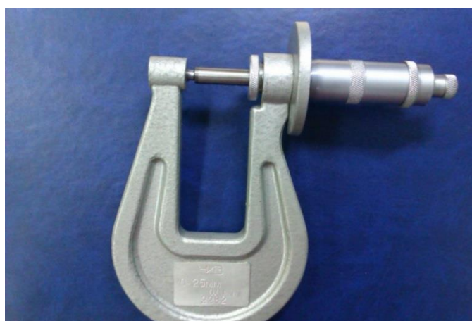
Рисунок 3 – Внешний вид микрометров типа МЛ
