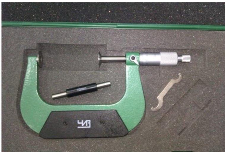
Рисунок 1 – Внешний вид микрометров типа МЗ
