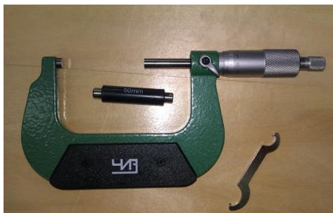
Рисунок 2 – Внешний вид микрометров типа МК
