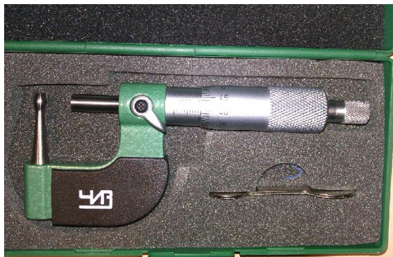
Рисунок 4 – Внешний вид микрометров типа МТ
