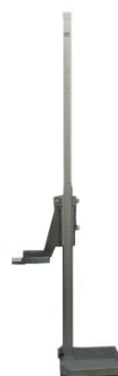
б) штангенрейсмас с измерительной ножкой
