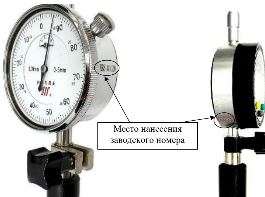
Рисунок 5 – Места нанесения заводских номеров на отсчетное устройство
