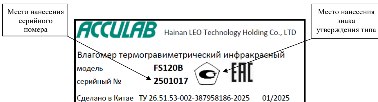
Рисунок 2 – Место нанесения серийного номера и знака утверждения типа на влагомеры термогравиметрические инфракрасные FS
