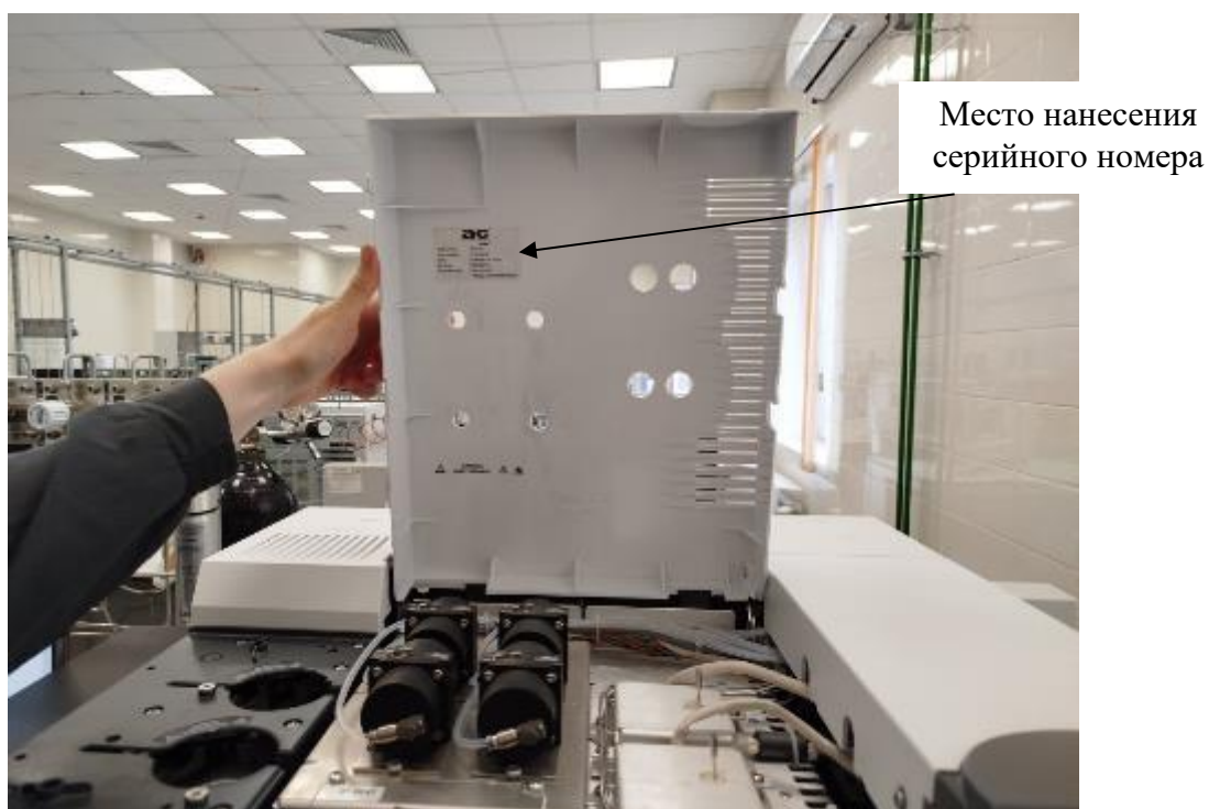
Рисунок 20 – Место нанесения серийного номера хроматографов газовых ССГ
