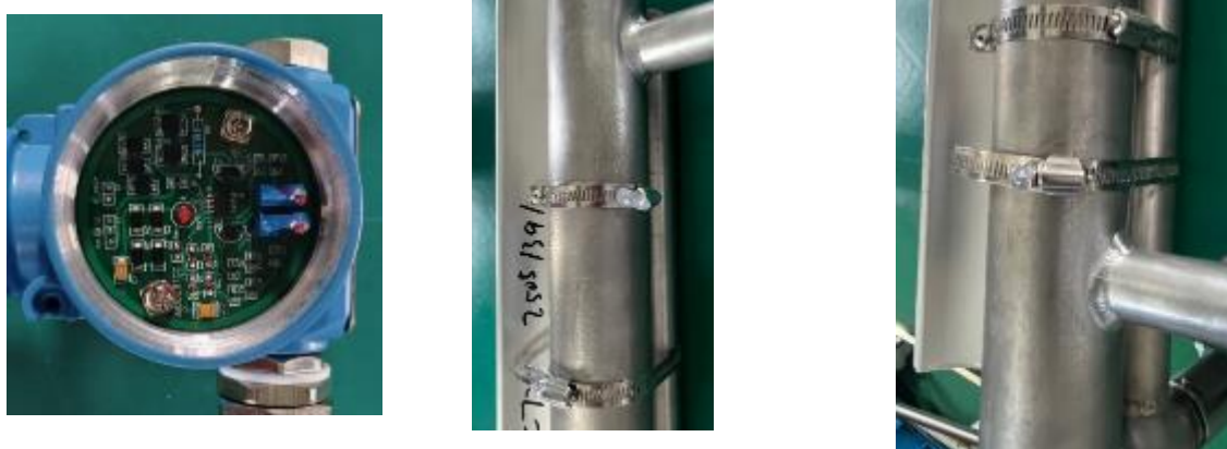
Рисунок 3 – Места пломбирования уровнемера
