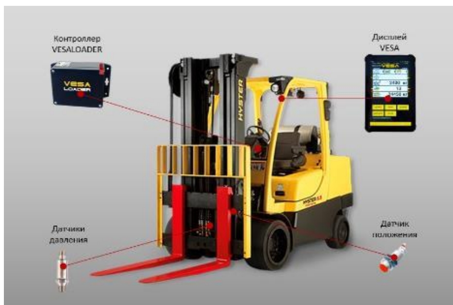
Рисунок 1 – Примеры (схемы) размещения частей средства измерений, смонтированного на фронтальном или вилочном погрузчике
