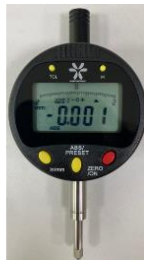
Рисунок 13 – Общий вид индикатора цифровой модификации 7112-10
