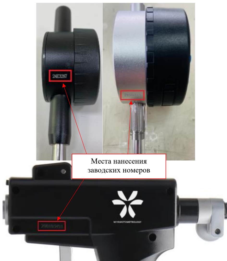
Рисунок 16 – Места нанесения заводских номеров на нутромеры модели 5151
