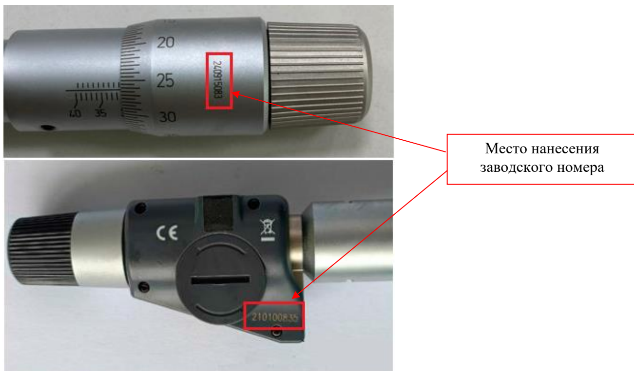
Рисунок 14 – Места нанесения заводских номеров на нутромеры моделей 5111, 5112, 5113, 5121, 5122, 5123
