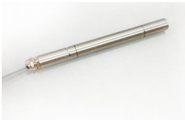
Рисунок 1 – Общий вид датчиков деформации струнных SVWG-01
