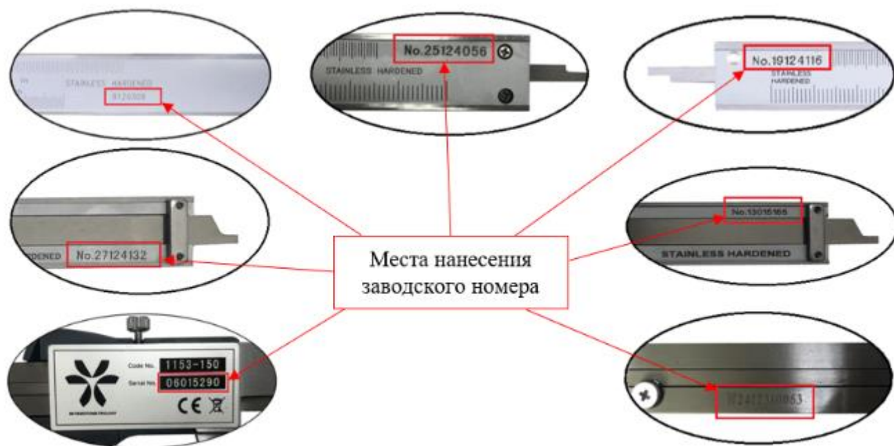
Рисунок 39 – Обозначение мест нанесения заводского номера на штангенциркули
