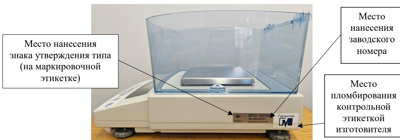
Рисунок 3 – Место пломбирования компаратора от несанкционированного доступа, место нанесения заводского номера, место нанесения знака утверждения типа
