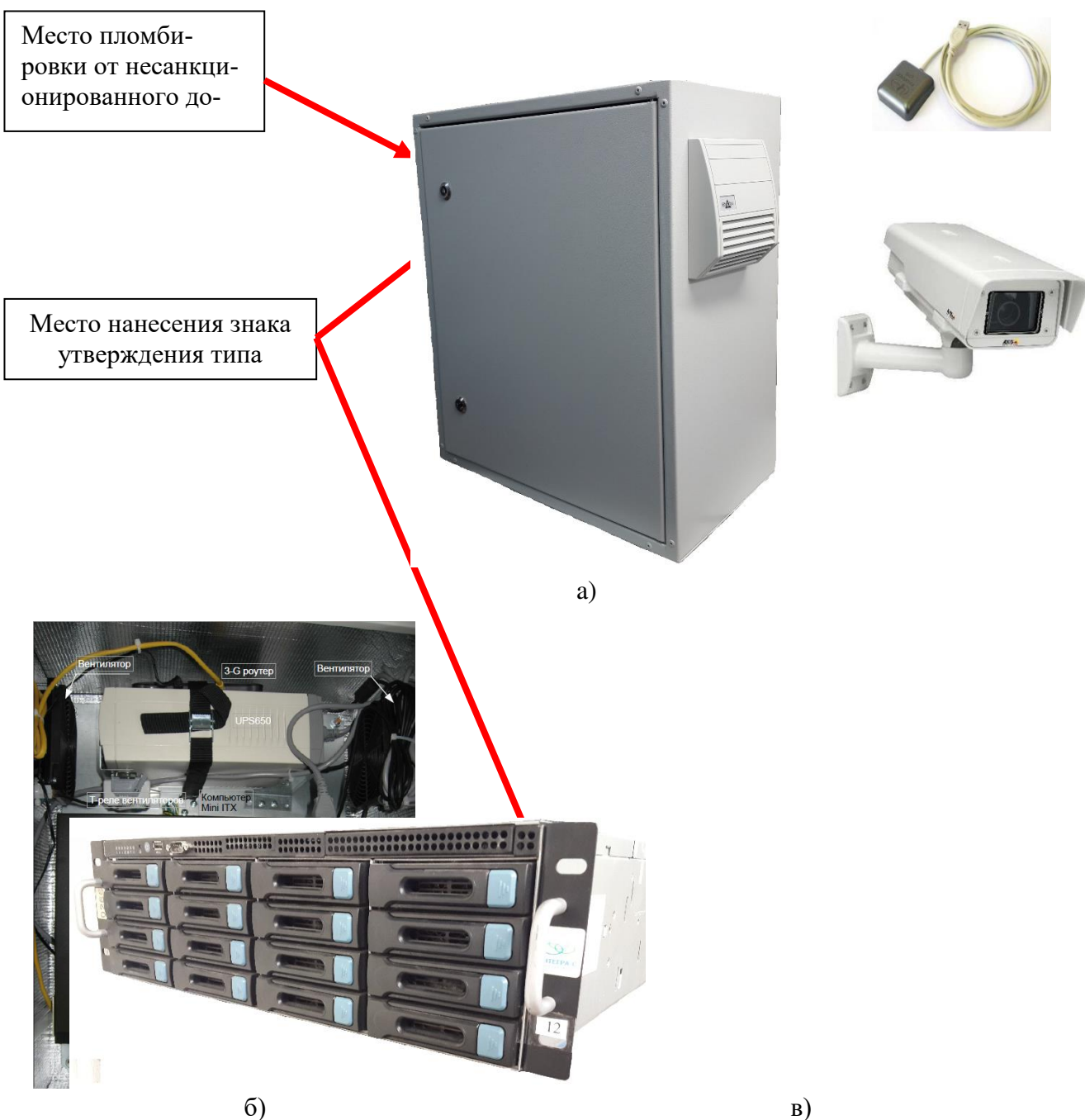
Рисунок 1 – Внешний вид системы а) уличный вариант исполнения ПАК; б) внутренняя часть ПАК; в) стационарный вариант исполнения ПАК
