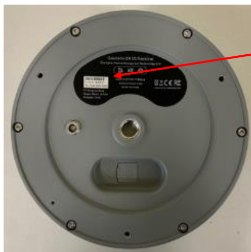
Рисунок 1 – Системы измерений перемещений и деформаций PrinCe H3: а) общий вид; б) место нанесения заводского номера средства измерений
