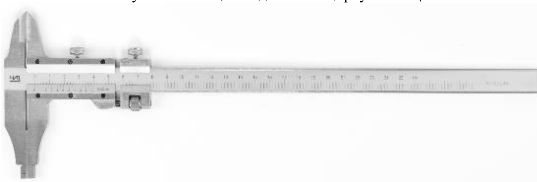
Рисунок 5 – Общий вид штангенциркулей ШЦ-II
