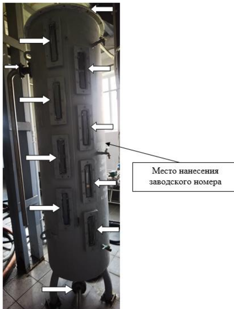
Рисунок 1 – Общий вид мерника металлического технического 1-го класса К7-ВМА и схема пломбировки от несанкционированного доступа, обозначение места нанесения знака поверки и место нанесения заводского номера
