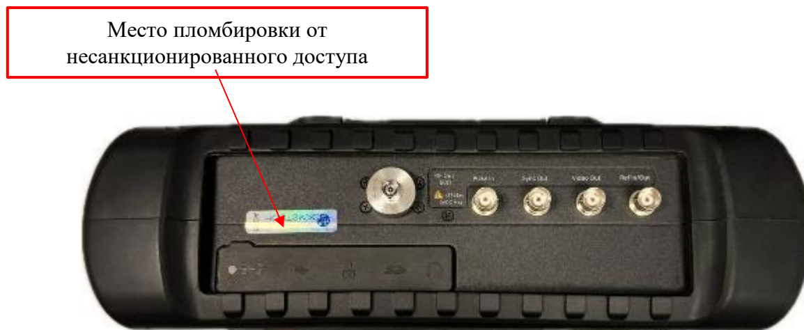
Рисунок 3 – Схема пломбировки от несанкционированного доступа
