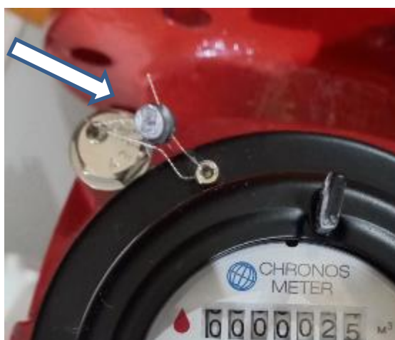
Рисунок 2 – Схема пломбировки от несанкционированного доступа и обозначение места нанесения знака поверки
