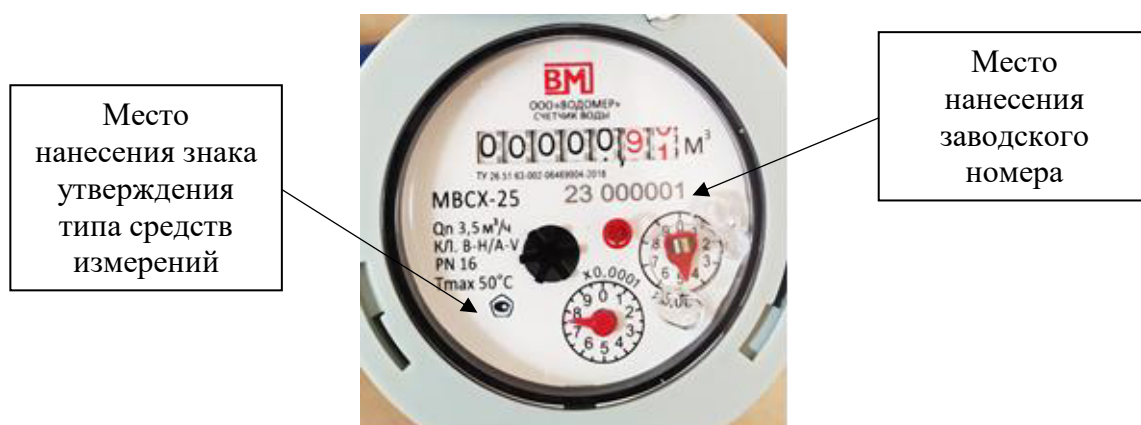
Рисунок 5 – Места нанесения заводского номера и знака утверждения типа средств измерений у счётчиков модификации МВС-01
