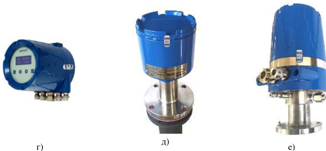
Рисунок 6 – Места пломбирования блоков газоанализаторов: а) LONOXТ4-TM, б) LONOCM5-TM, LONOCM6-TM, в) LONOCM7-TM, г) SERVOCС61-TM, д) LONOXТ4-PM, LONOCM5-PM, TES300-PM, LONOCM7-PM, е) SERVOCС61-TM
