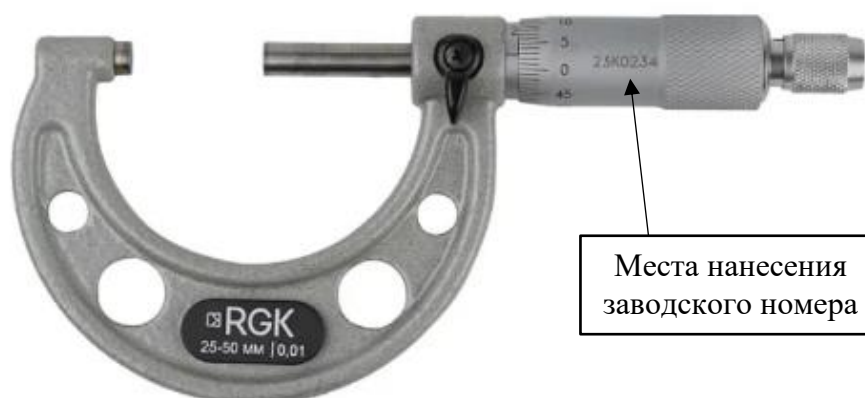
Рисунок 3 – Общий вид микрометров модификаций МРМ-50, МРМ-75, МРМ-100 с указанием мест нанесения заводского номера
