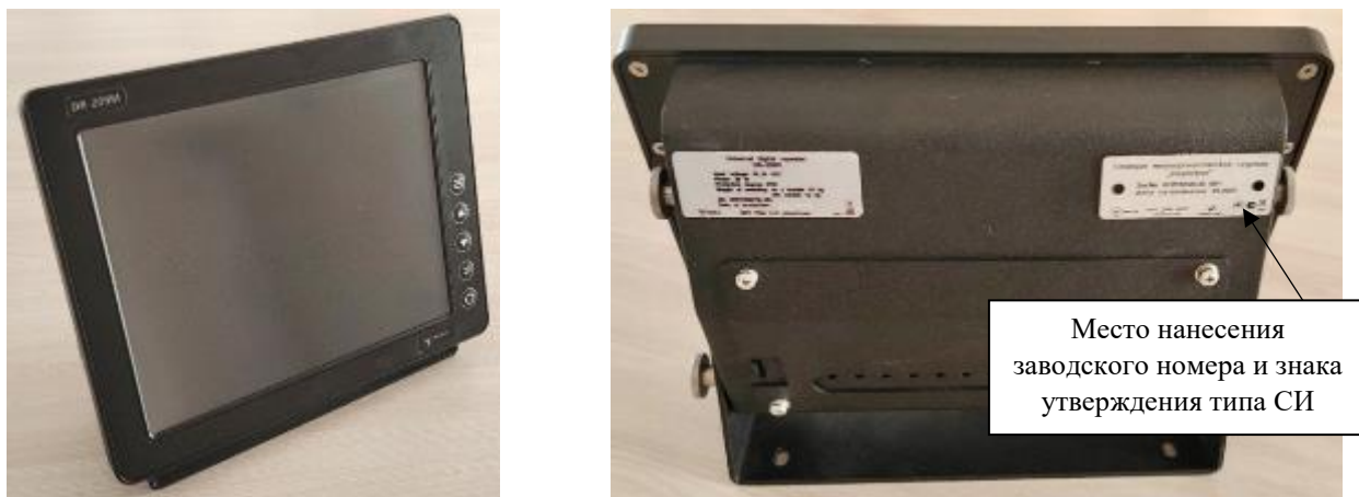
Рисунок 2 – Общий вид репитера с указанием места нанесения заводского номера и знака утверждения типа СИ
