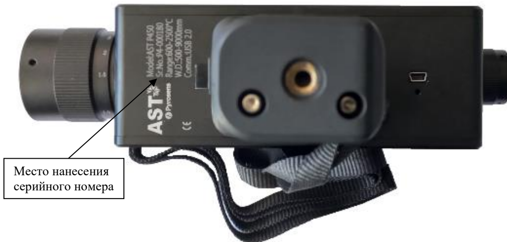
Рисунок 2 – Место нанесения серийного номера
