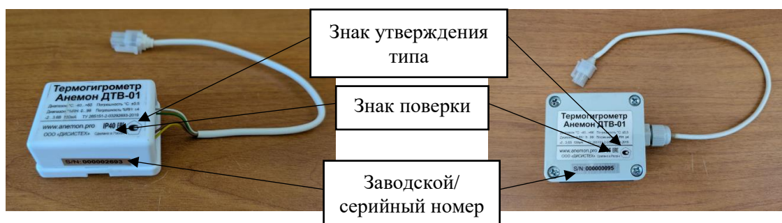
Рисунок 1 – Общий вид термогигрометров с указанием мест нанесения знака утверждения типа, знака поверки и заводского/серийного номера
