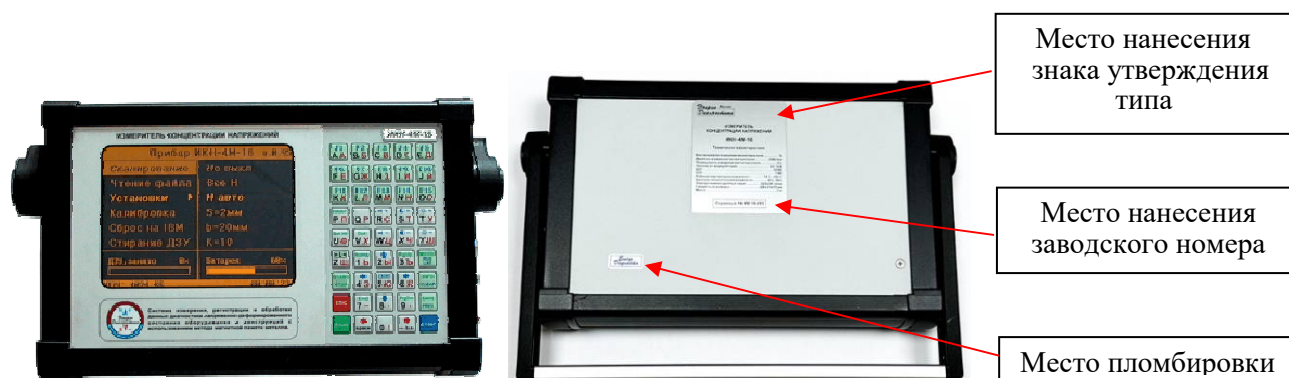
Рисунок 4 – Общий вид прибора модификации ИКН-3М-12, обозначение мест нанесения знака утверждения типа, пломбировки и нанесения заводского номера
