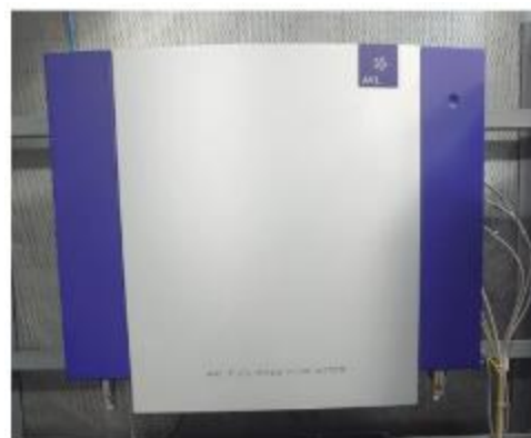
Рисунок 8 – Массовый расходомер топлива AVL 735
