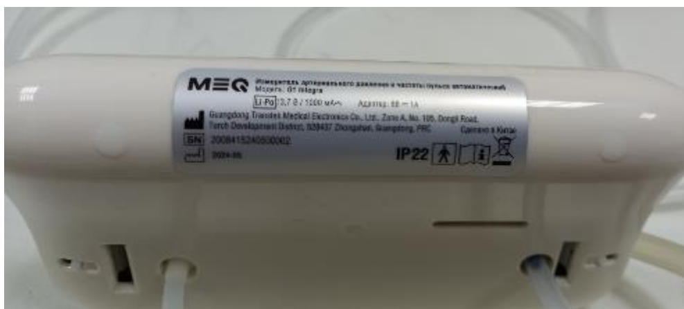
Рисунок 2 – Схема маркировки измерителя артериального давления и частоты пульса автоматического MEQ G1 Integra
