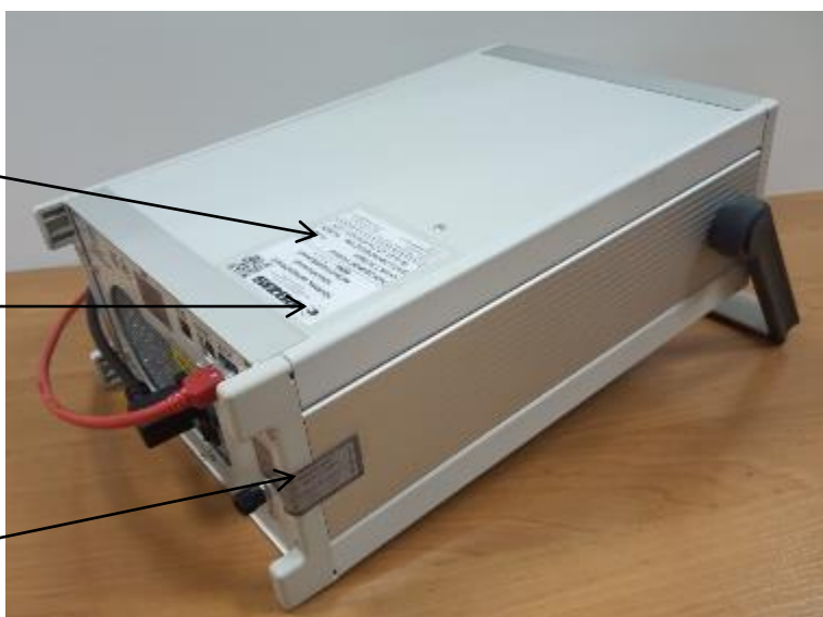
Рисунок 2 – Место нанесения заводского номера, знака утверждения типа, пломбировки от несанкционированного доступа
