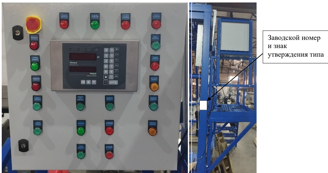
Р и с у н о к 2 – Шкаф управления, обозначение места нанесения заводского номера и знака утверждения типа
