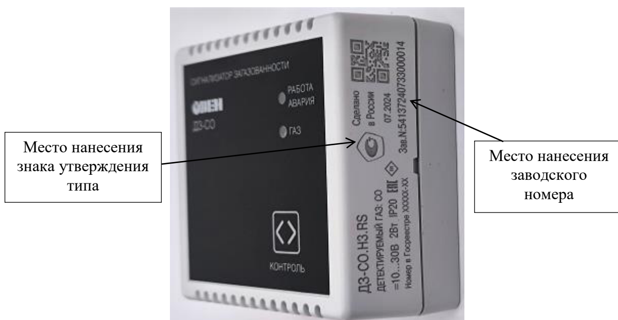
Рисунок 2 – Общий вид сигнализаторов исполнения ДЗ-СО в корпусе Н3 с указанием мест нанесения заводского номера и знака утверждения типа
