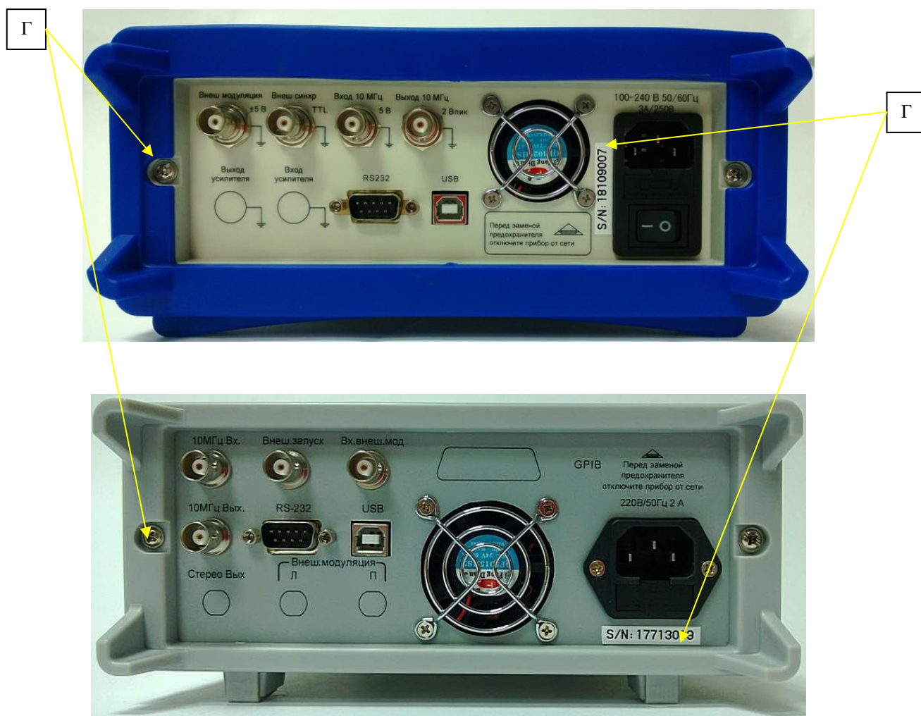
Рисунок 2 – Вид задней панели генераторов с местом нанесения серийного номера (Г) и схемой пломбировки от несанкционированного доступа (В)
