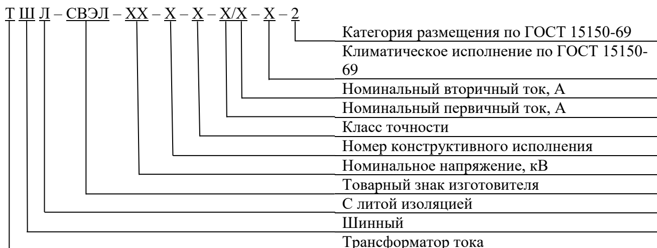
Рисунок 4 – Структура условного обозначения трансформаторов тока ТШЛ-СВЭЛ
