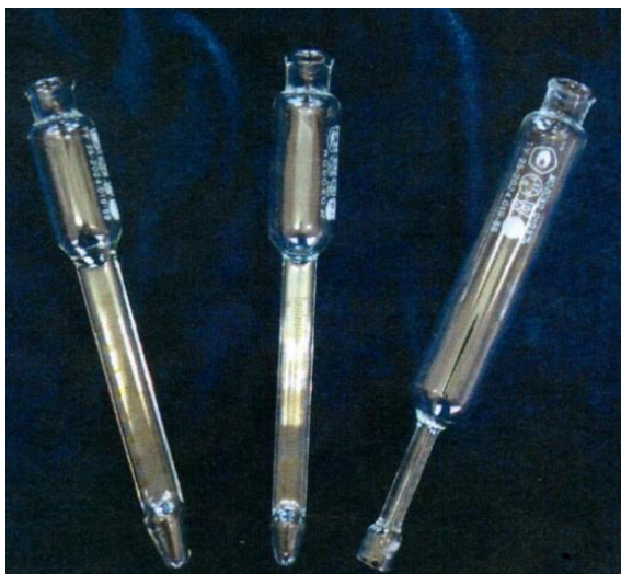
Рисунок 1 – Общий вид бутирометров стеклянных исполнений 1-6, 1-40, 2-0,5
