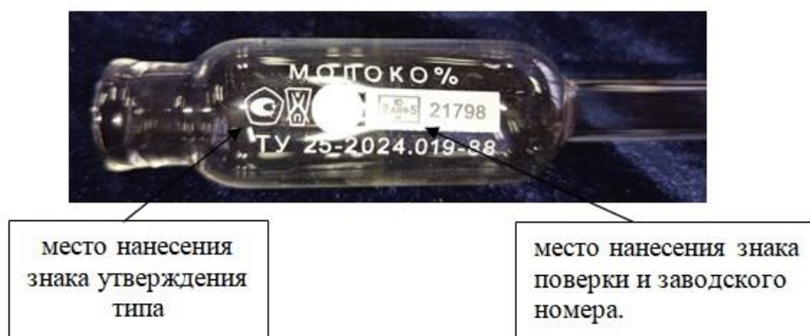
Рисунок 2 – Общий вид бутирометров стеклянных с указанием мест нанесения знака утверждения типа, знака поверки и заводского номера
