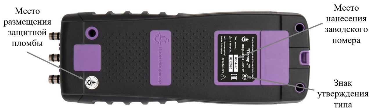
Рисунок 2 – Схема пломбировки газоанализаторов от несанкционированного доступа и места нанесения заводского номера и знака утверждения типа
