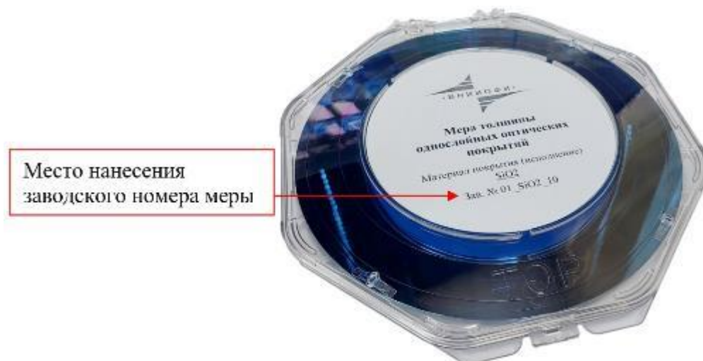
Рисунок 1 – Общий вид индивидуального герметичного пластикового контейнера с мерой толщины однослойных оптических покрытий
