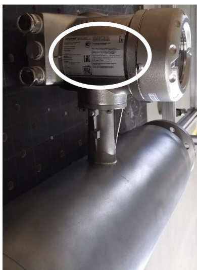
Рисунок 3 – Место нанесения маркировочной таблички
