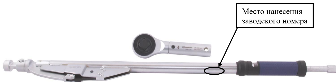
Рисунок 2 – Общий вид ключей моментных предельных СТWBD модификаций СТWBD-4-600, СТWBD-4-800, СТWBD-5-600, СТWBD-5-800, с местом нанесения заводского номера
