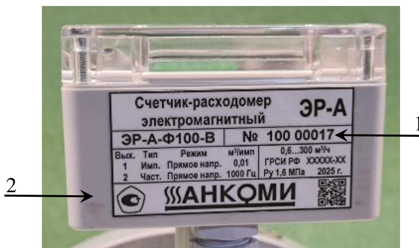
Рисунок 5 – Места нанесения заводского номера и знака утверждения типа
