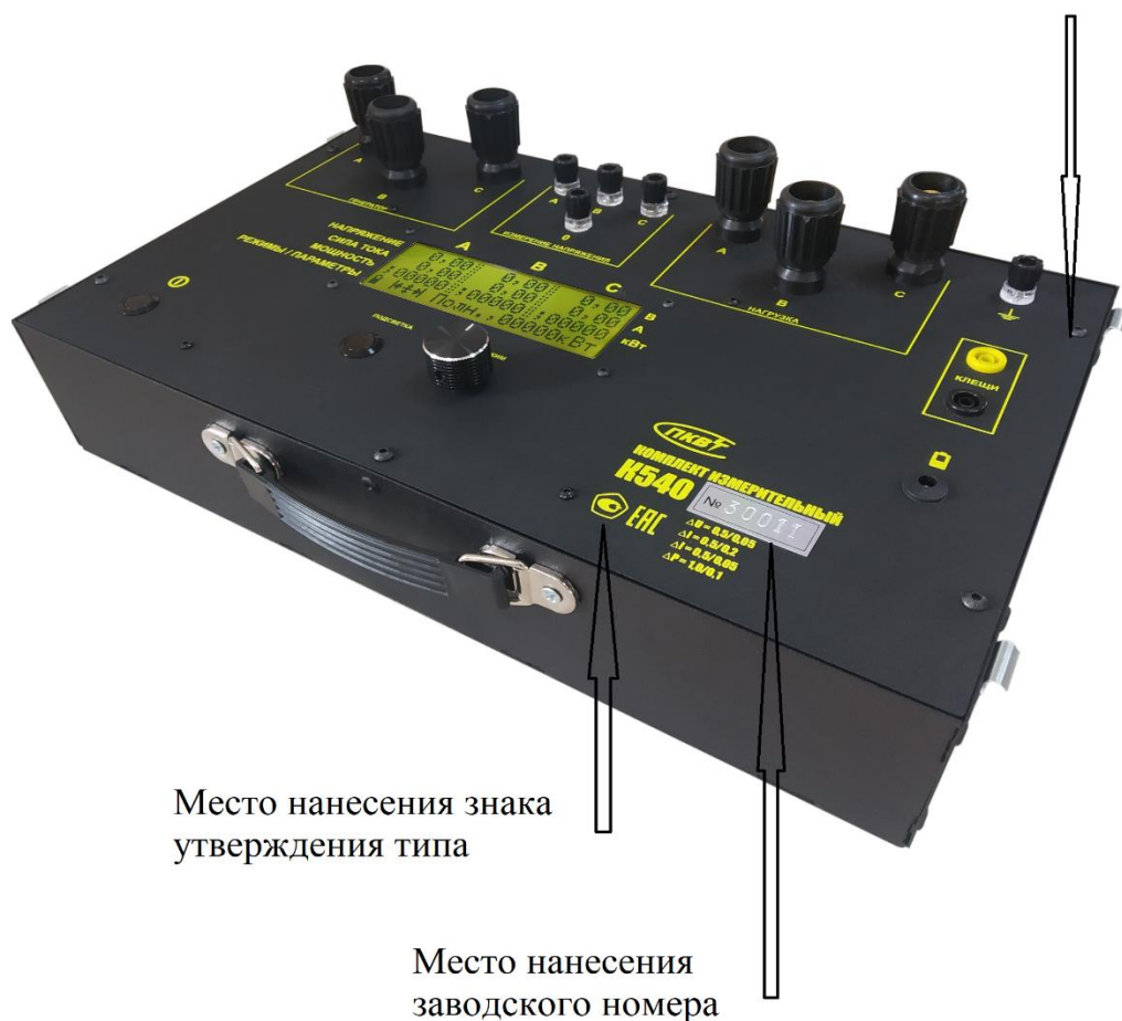
Рисунок 2 – Место пломбирования от несанкционированного доступа, место нанесения знака утверждения типа и заводского номера
