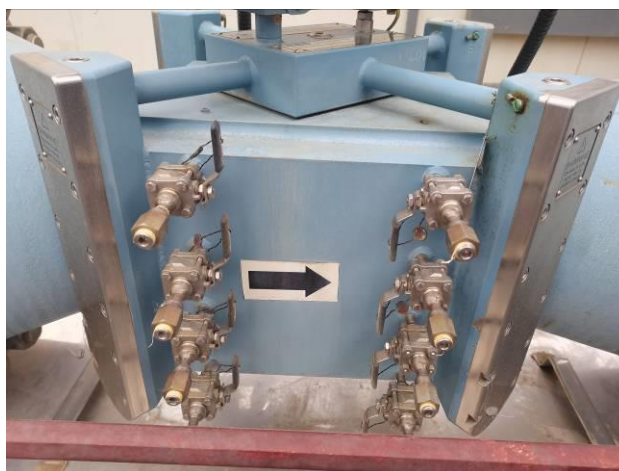
Рисунок 1а – Схема пломбировки блоков ПАП на корпусе УЗР
