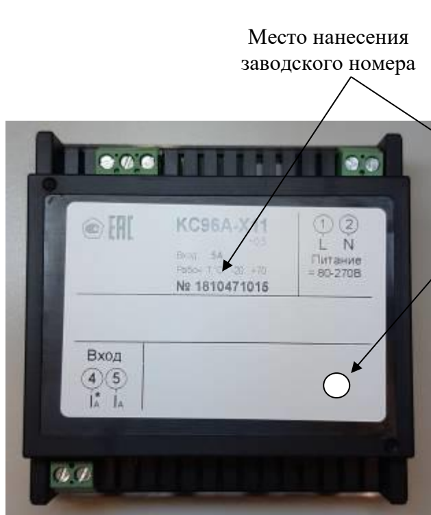
Рисунок 12 – Общий вид приборов KC96A (однофазная модификация). Вид сзади
