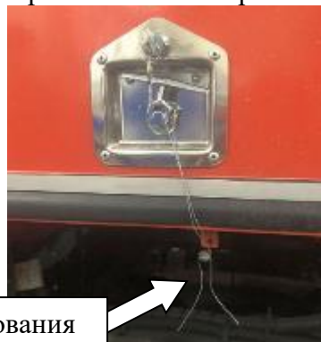
Рисунок 3 – Запорный механизм крышки заливной горловины и кран сливной отстойника
