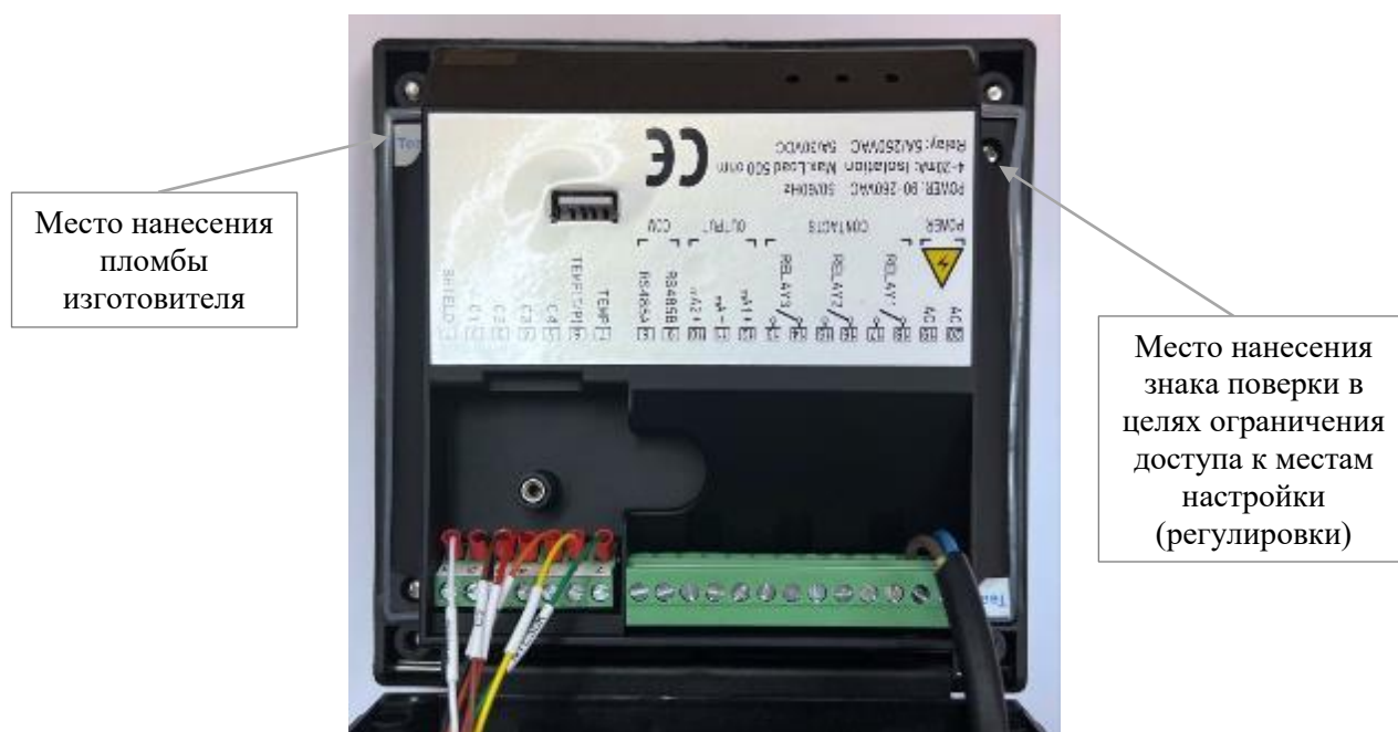
Рисунок 3 – Место нанесения знака поверки в целях ограничения доступа к местам настройки (регулировки) и места пломбирования внутри преобразовательного блока
