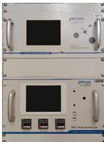
Рисунок 2 – Общий вид инфракрасного Фурье-спектрометра Zetian FT-3000 (на фото сверху) и ультрафиолетового дифференциального оптического абсорбционного спектрометра Zetian EM-5 (на фото снизу)
