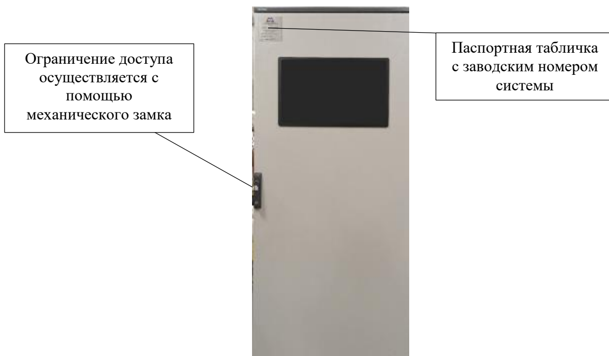
Рисунок 1 – Общий вид шкафа, в котором расположен инфракрасный Фурье-спектрометр Zetian FT-3000
