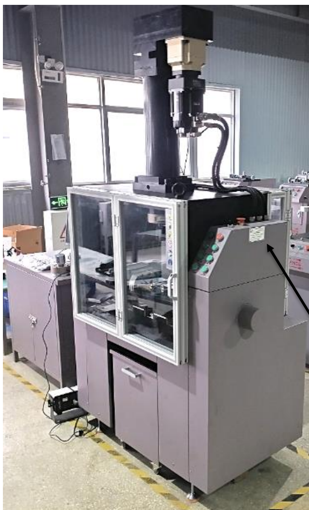
Рисунок 1 – Общий вид машины испытательной ЕВТ105А с указанием места нанесения маркировочной таблички с заводским номером
