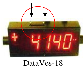
Рисунок 4 – Общий вид прибора и схема пломбирования
