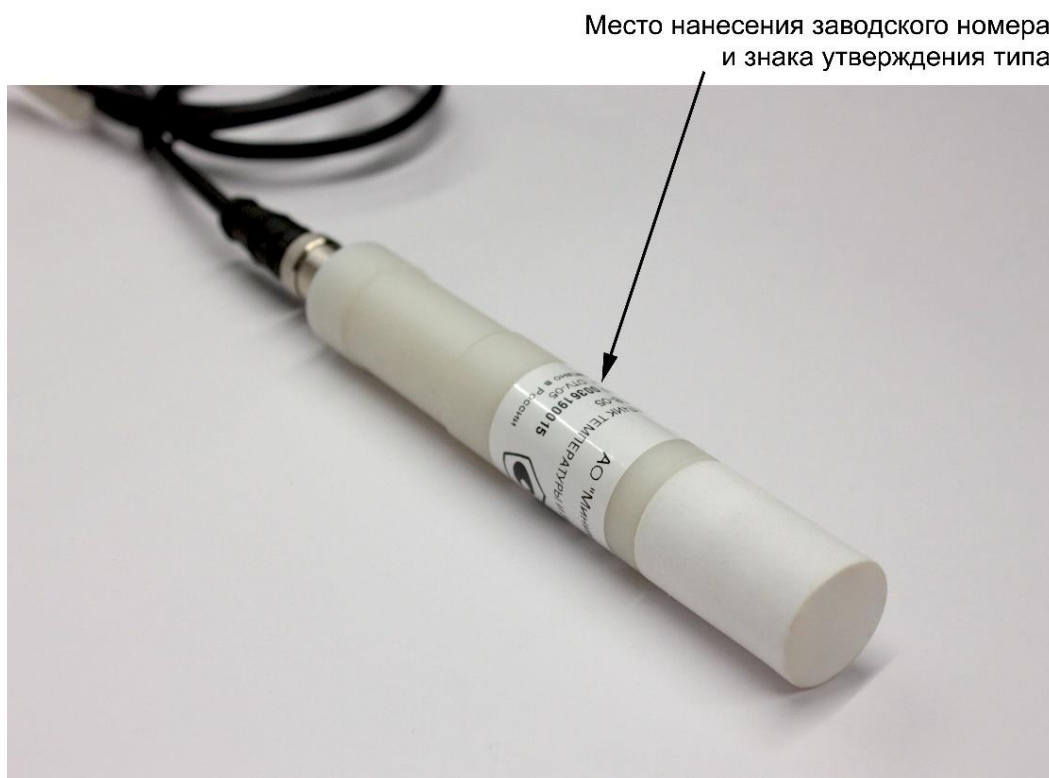
Рисунок 1 – Общий вид датчиков температуры и влажности воздуха ДТВ-05 и ДТВ-05-02 с указанием места нанесения заводского номера и знака утверждения типа
