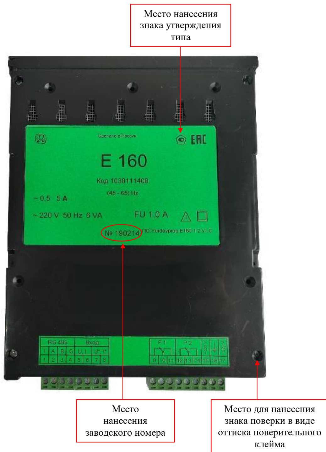
Рисунок 5 – Фотография общего вида измерителя E160.1 и измерителя E160.2 с указанием места нанесения знака утверждения типа, заводского номера и места нанесения знака поверки в виде отиска поверительного клейма, нанесенного на мастичную пломбу, закрывающую доступ к винту крепления верхней крышки корпуса измерителей
