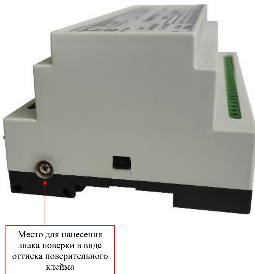
Рисунок 9 – Фотография общего вида измерителя Е160.5 с указанием места нанесения знака поверки в виде оттиска поверительного клейма, нанесенного на мастичную пломбу, закрывающую доступ к винту крепления верхней крышки корпуса измерителя
