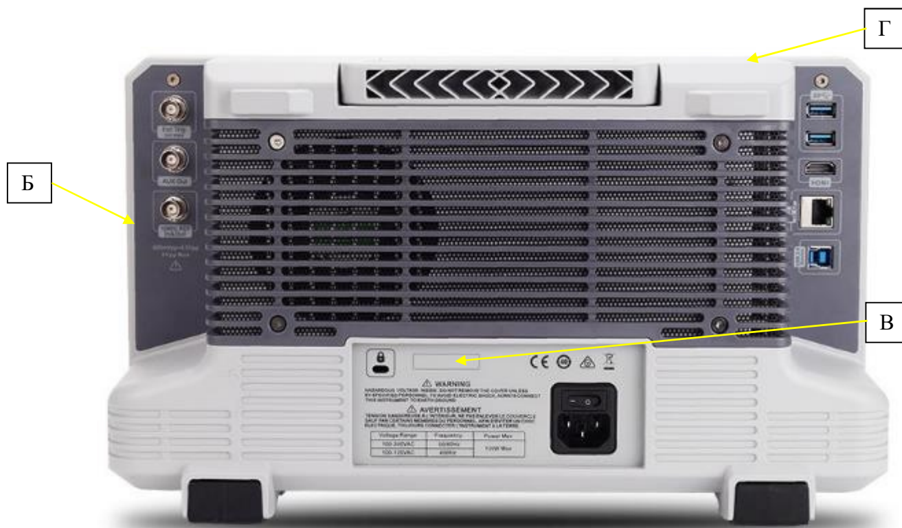
Рисунок 2 – Вид задней панели осциллографов, место пломбировки от несанкционированного доступа (Б), место нанесения серийного номера (В) и знака поверки (Г)
