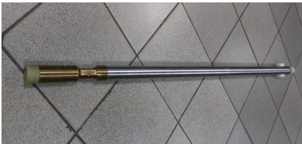
Рисунок 2 – Внешний вид забойной части модуля инклинометрии ЕС.12.01.00.00.000-01
