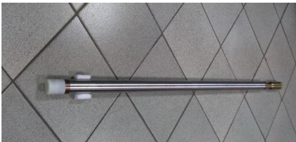
Рисунок 1 – Внешний вид забойной части модуля инклинометрии ЕС.12.01.00.00.000
